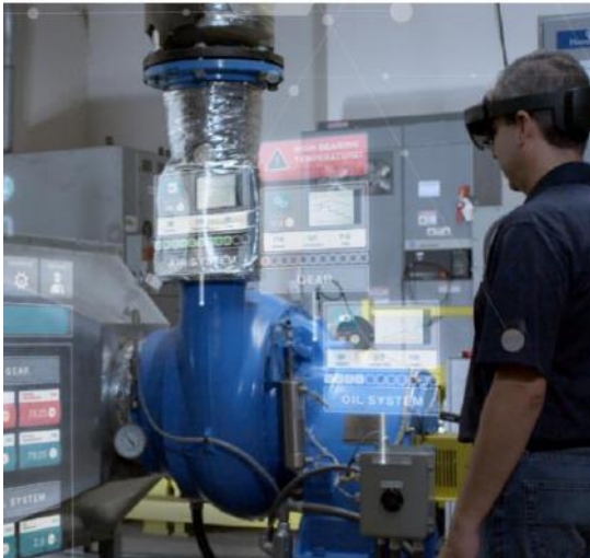
图表52： PTC+Microsoft 混合现实技术提供直观设备运维视图
